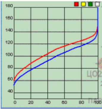
Каждый график снабжен независимыми фиксаторами параметров ■ ■ □, которые позволяют наблюдать изменения, происходящие с кривыми кипения.
