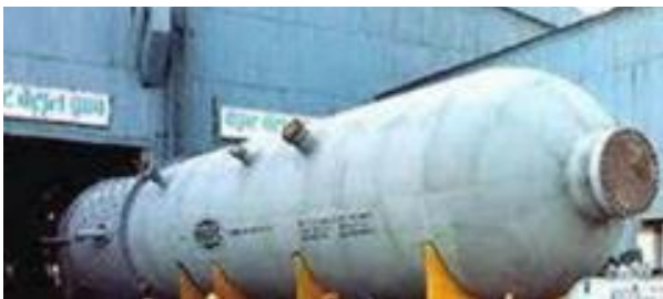
130-ти тонный реактор гидроочистки дизельного топлива.
