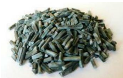
Катализатор гидроочистки дизельных фракций НК-232 ( Новокуйбышевский завод катализаторов). https://www.slideserve.com/tien/4919620
