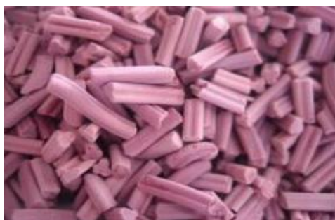
Катализатор ИК-ГО-1 глубокой гидроочистки дизельных топлив (Институт катализа СО РАН)
