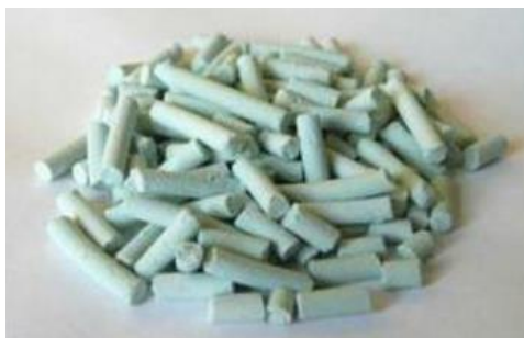
Катализатор гидроочистки дизельных фракций НК-233 ( Новокуйбышевский завод катализаторов). https://www.slideserve.com/tien/4919620
