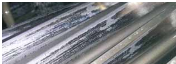
Foto 01. Ulatuslik mikropiting ja piting hammaste kontaktpindadel
